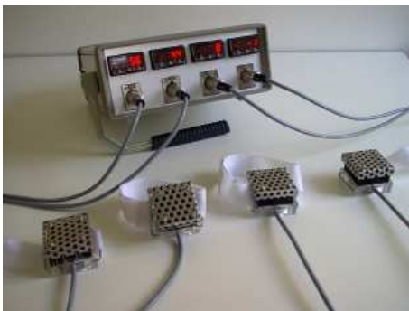
Gerät zur kontrollierten Abkühlung oder Erwärmung von Hautpartien mit 4 Temperaturmanschetten
